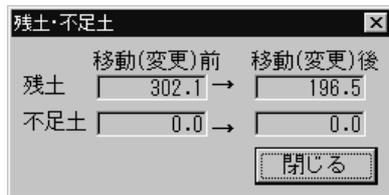
現在《測点・土量ウィンドウ》によって選択された（カーソルがある位置の）測点に対して行われた、「測点間の土量移動」による、残土・不足土の変化を表示します。
